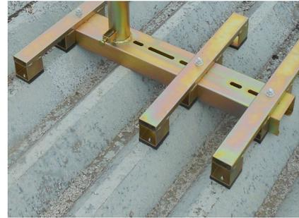
③ ベースにハイテン支柱を挿し込み、ストッパーピンでロックしてM10ボルトを締め込み固定する。
